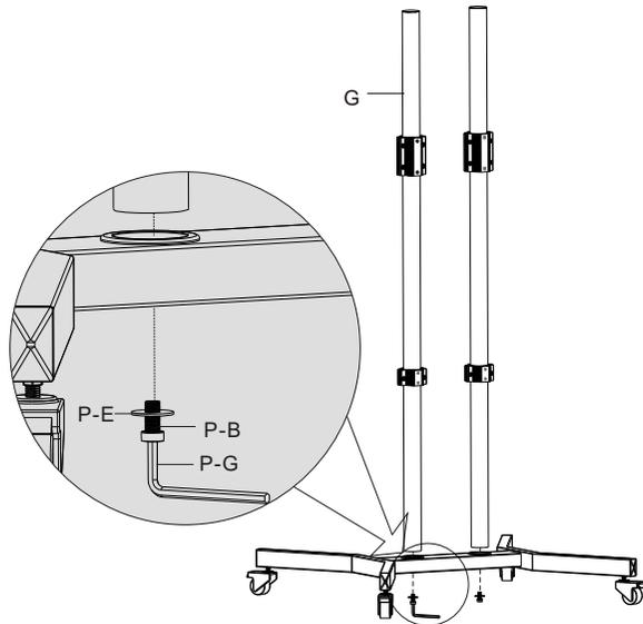
Adjunte dos pilares a la base usando tornillos y golillas, apriete los tornillos usando la llave Allen de 8mm
