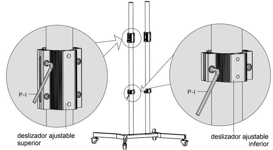
Suelte los tornillos del deslizador ajustable y ajústelo a la posición deseada usando la llave Allen de 5mm.
