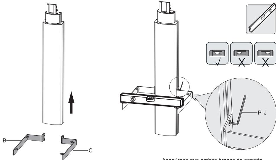
Mueva los brazos de soporte a través de los rieles de la columna hasta la altura deseada
