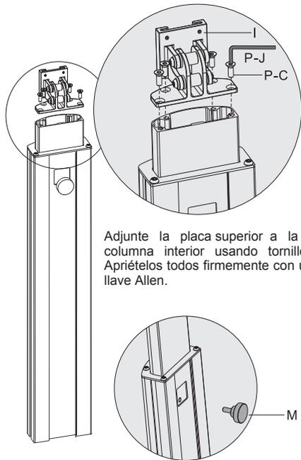
Adjunte la placa superior a la columna interior usando tornillos. Apriételes todos firmemente con una llave Allen.
