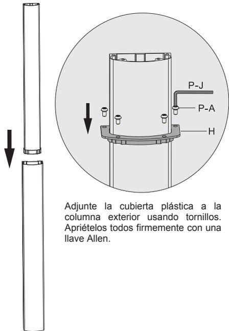
Adjunte la cubierta plástica a la columna exterior usando tornillos. Apriételes todos firmemente con una llave Allen.
