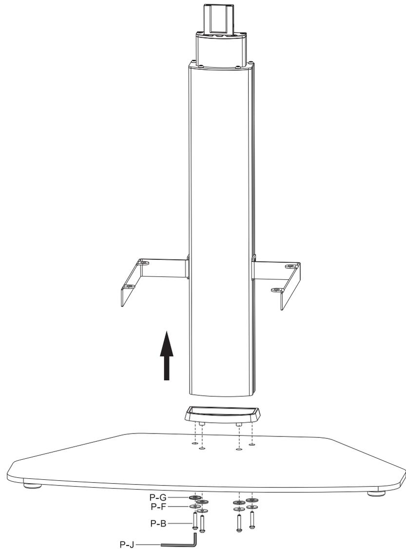
Adjunte la columna y la tapa de pie a la base usando tornillos y golillas. Apriételes todos con la llave Allen
