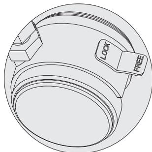
Bloquee los frenos de las ruedas para evitar movimientos indeseados durante la instalación
