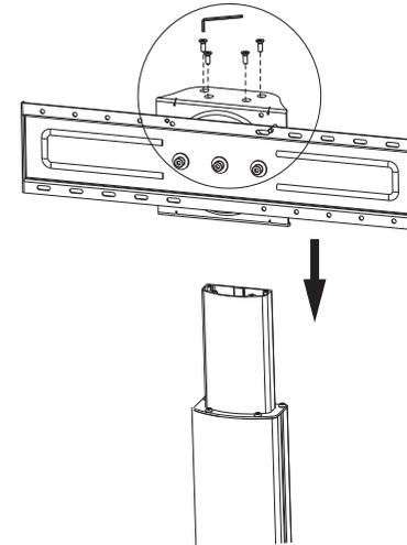
Inserte la placa superior dentro de la columna y asegure con tornillos
