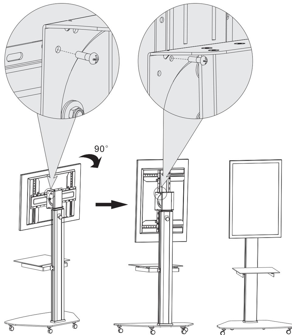
Remueva el tornillo de la placa superior para rotar el TV. Vuelva a asegurar el tornillo una vez finalizado
