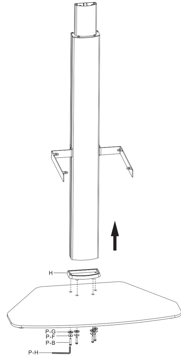
Adjunte la columna y la tapa de pie a la base usando tornillos y golillas. Apriételes todos con la llave Allen
