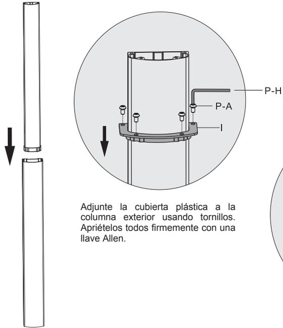
Adjunte la cubierta plástica a la columna exterior usando tornillos. Apriételes todos firmemente con una llave Allen.
